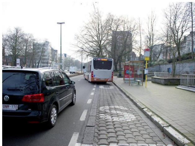
Figure 4 : Arrêt en encoche
